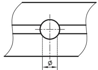
Die Bohrung  $\varnothing$  ermöglicht einen seitlichen Verbinderausgang für eine parallel-Verbindung an irgend einer Stelle am Profil.
