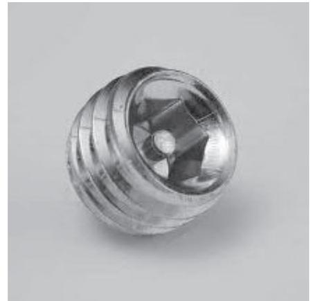
Spezial PVS®-Schraube Safe M12x12 für Sicherheits-Konstruktionen, die für nicht autorisierte Personen undemontierbar sein müssen. Ein Stift verhindert den Zugang zum Öffnen der Schraube mit einem handelsüblichen Inbusschlüssel.
