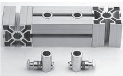
Die abgefrästen Ankerköpfe erlauben das nachträgliche Anbauen der Profile. Um jede Profilstellung zu gewährleisten, sind horizontal und vertikal gefrästen Ankertypen nötig. **Auch in rostfreier Ausführung oder mit Potentialausgleich lieferbar. (elektrisch leitend)**
