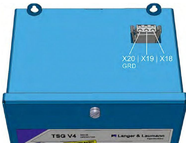
Abb. 11: TSG Elektronik intern – Netzspannungsanschluss
