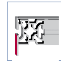
d) Einklemmschutz für rücklaufenden Gurt
