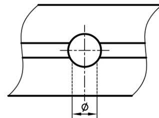
Die Bohrung Ø ermöglicht einen seitlichen Verbinderausgang für eine parallel-Verbindung an irgend einer Stelle am Profil.
