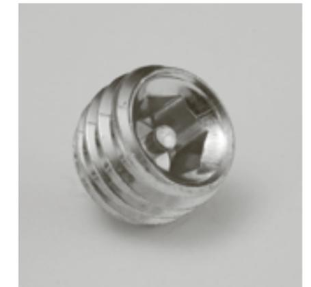
Spezial PVS®-Schraube Safe M12x12 für Sicherheits-Konstruktionen, die für nicht autorisierte Personen undemontierbar sein müssen. Ein Stift verhindert den Zugang zum Öffnen der Schraube mit einem handelsüblichen Inbusschlüssel.
