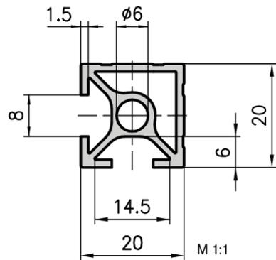
Bei allen D-Profilen mit Bohrungen Ø6 können M6-Gewindeinsätze Heli Coil (DIN 8140) eingesetzt werden. Bearbeitungscode: H3/H4.
