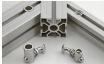
Mit dem gebogenen Ankerkopf – 15°, 30° sowie 45° in linker und rechter Ausführung – oder mit Gelenkkopf können Verbindungen in beinahe jedem Winkel problemlos erstellt werden.
