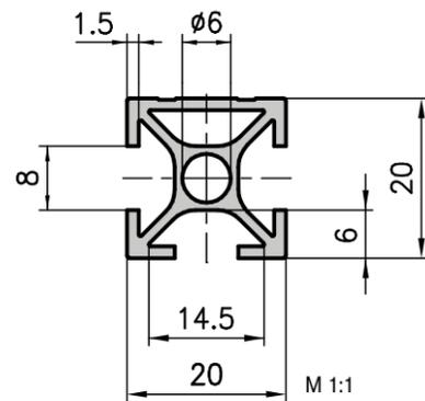
Die Profile 20x20/40 eignen sich zudem als Verstärkungs- oder Auflageprofile hinter Flächenelementen, die in Kombination mit den Verkleidungsprofilen der Basis 30 eingesetzt werden (siehe Skizze).
