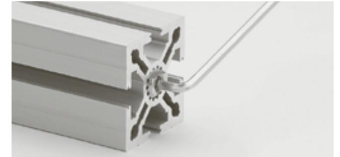
2. Im Profil eine Stufenbohrung anbringen
