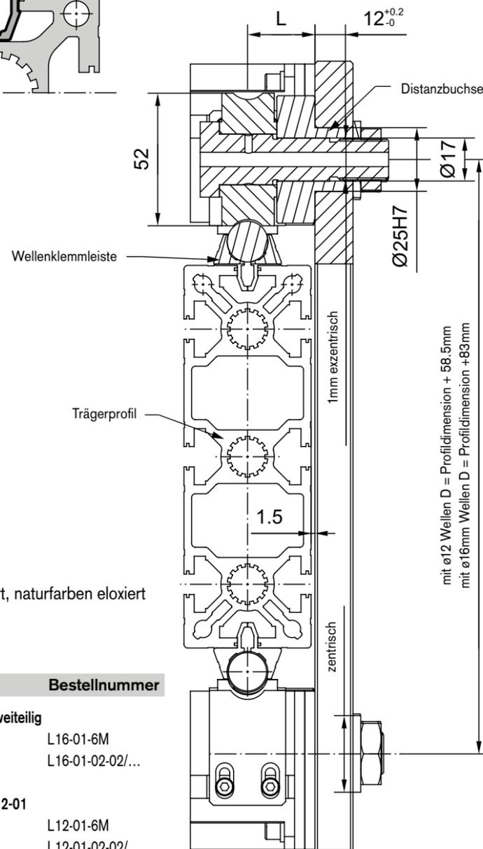
mit Ø12 Wellen D = Profildimension + 58.5mm
