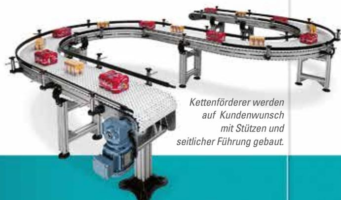
Kettenförderer werden auf Kundenwunsch auf Stützen und seitlicher Führung gebaut.
