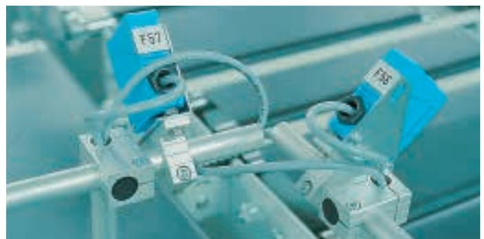
Fotozellen-Befestigung leicht justierbar.
