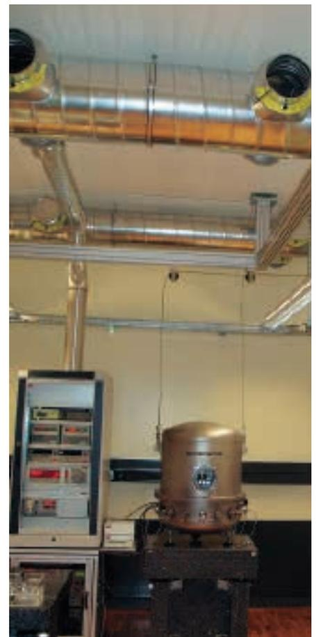
Laboreinrichtung mit Deckentragsystem
