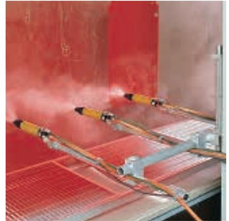
Zerstäuberhalterung einer Pulverbeschichtungsanlage. Dank geringem Haltergewicht sind die Beschleunigungs- und Verzögerungskräfte klein. Die Elemente haben gute elektrische Leiteigenschaften.
