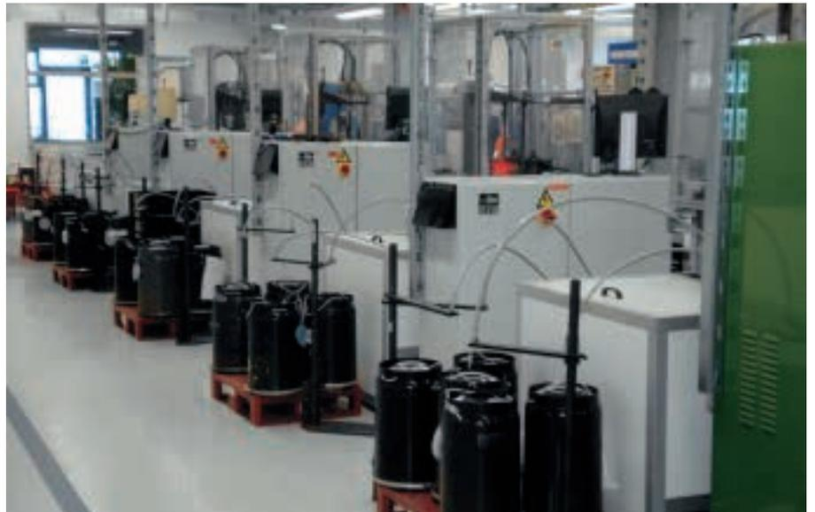
Lärmschutzverkleidung für Wickelmaschinen
