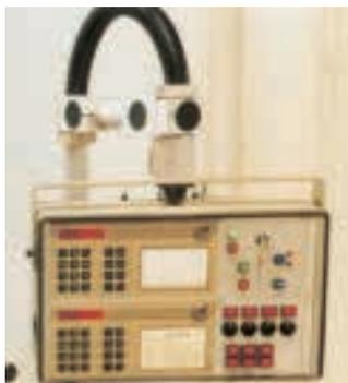
Verstellbare Halterung eines Steuerungskastens.
