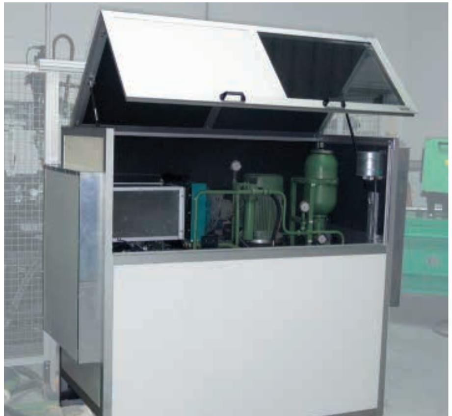
Lärmschutz für Hydraulikaggregat
