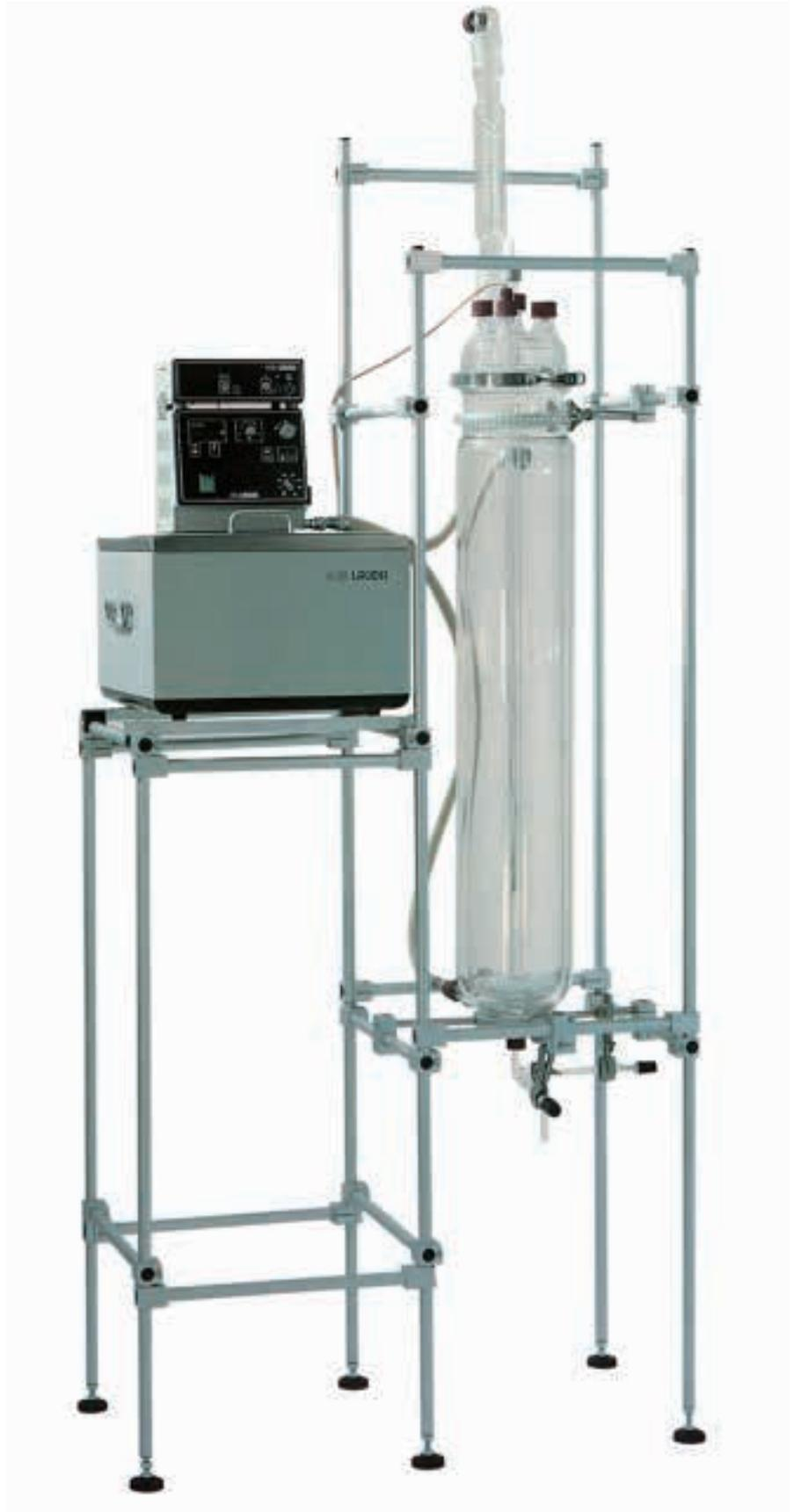
Blasensäulenreaktor für Flüssig-/Gasphase-Reaktionen mit Temperiermantel und Begasungseinrichtung.
