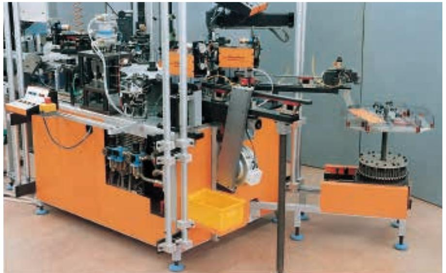
Führung zu Schutzverkleidung an Montageautomat mit Gewichtsausgleich in den Alu-Rohren.
