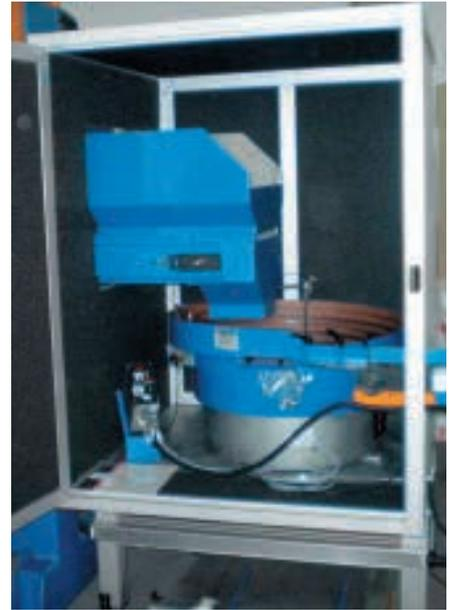
Lärmschutzverkleidung für Vibrationsförderer
