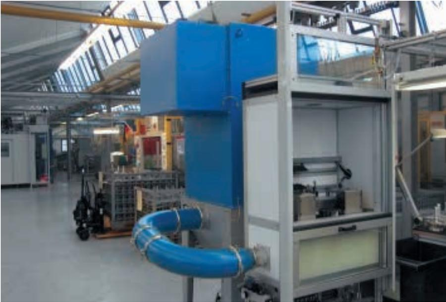
Lärmschutzkabine für Teile-Reinigungsanlage
