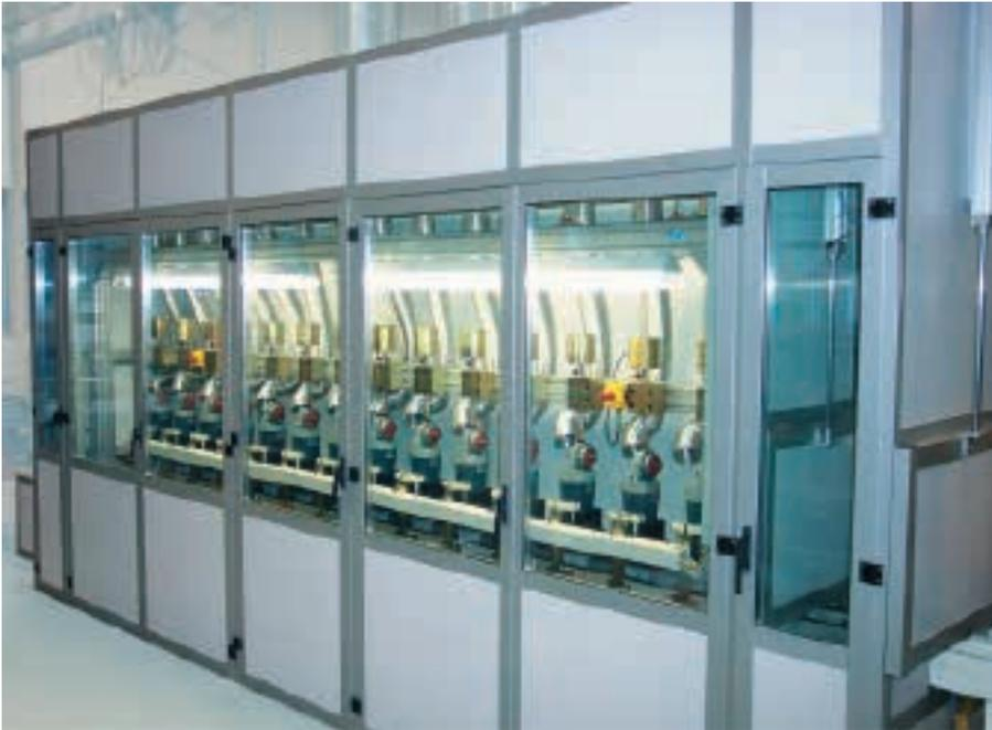
Dauerlaufprüfstand für 2-Hand-Winkelschleifer mit Lärmschutzschleusen
