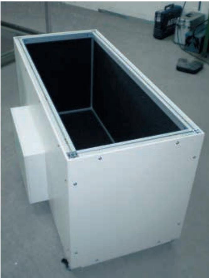
Fahrbares Lärmschutzgehäuse mit Lüftungssystem für eine Vakuumpumpe
