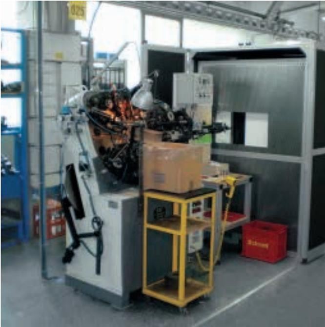
Schallschutzkabine auf Schienen, geöffnet und geschlossen
