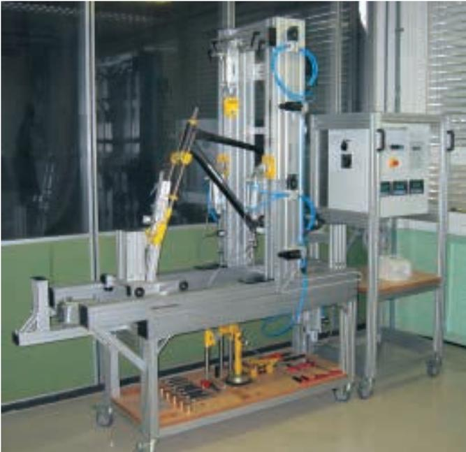
Prüfstation für Karbon Fahrrad-Rahmen
