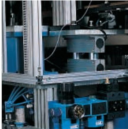
Einfach verstellbare Handling-Geräte-Träger.
