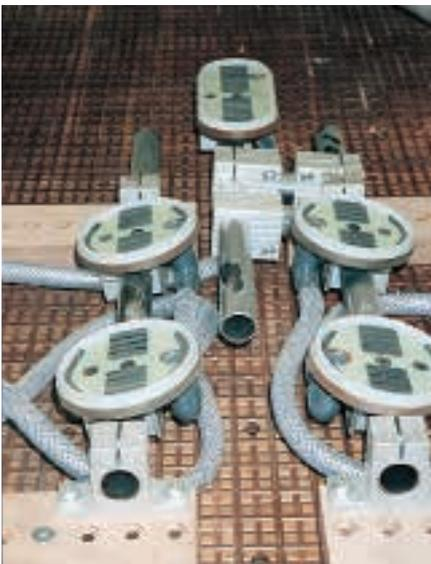
Anpassbare Vakuumteller für die Bearbeitung verschiedener Stuhllehnen.
