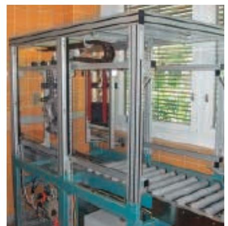
Abdeckung eines Stapelgerätes für die Sterilisation
