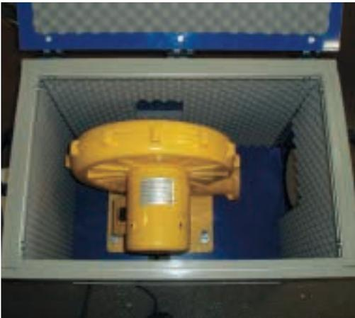
Schallschutzkasten für Gebläse
