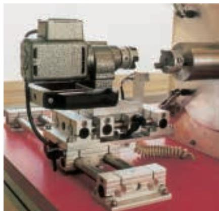
An- und abkuppelbarer Antrieb auf X/Y-Verstell-einheit zu einer Mikroschicht-Beschichtungstrommel. Elektromotor in abgekuppelter Position.
