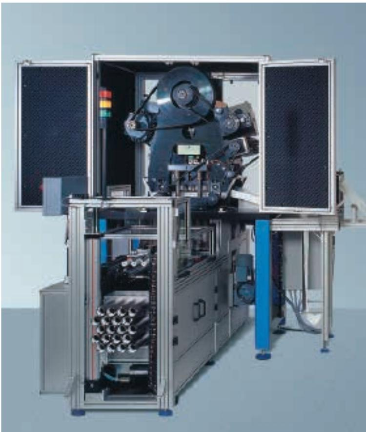
Stanzautomat mit Schallschutzhaube
