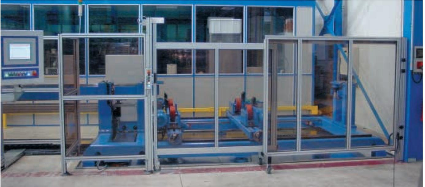
Verschaltung für Entgratungsanlage mit Sicherheitsglas
