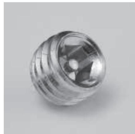
Spezial PVS®-Schraube Safe M12x12 für Sicherheits-Konstruktionen, die für nicht autorisierte Personen undemontierbar sein müssen. Ein Stift verhindert den Zugang zum Öffnen der Schraube mit einem handelsüblichen Inbusschlüssel.
