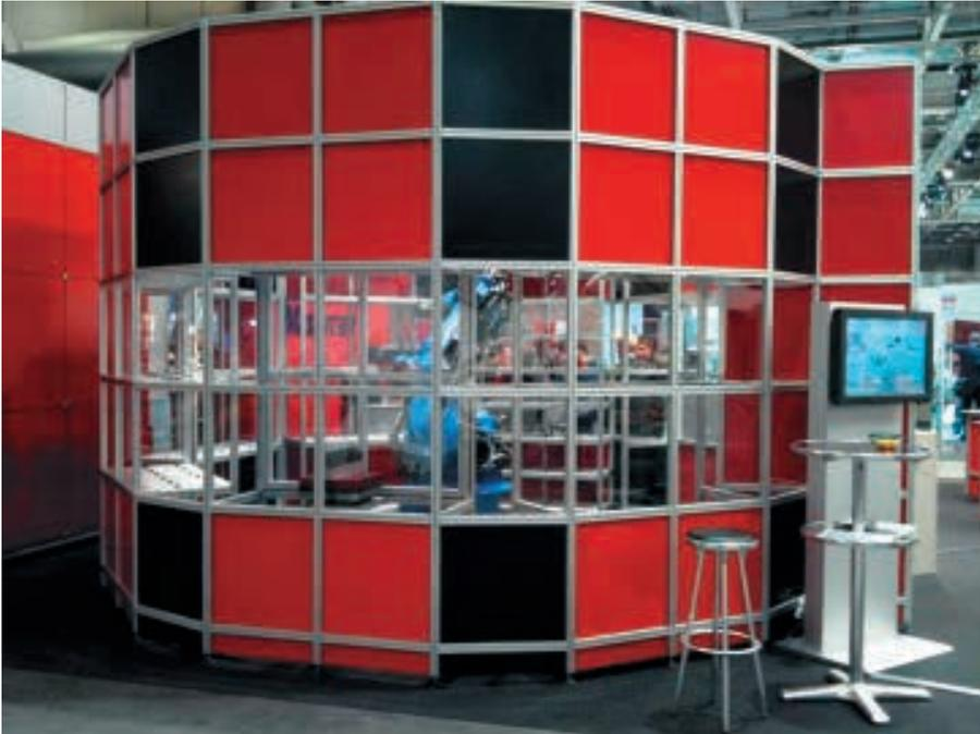
Schutzzelle und Lagergestell um Roboter
