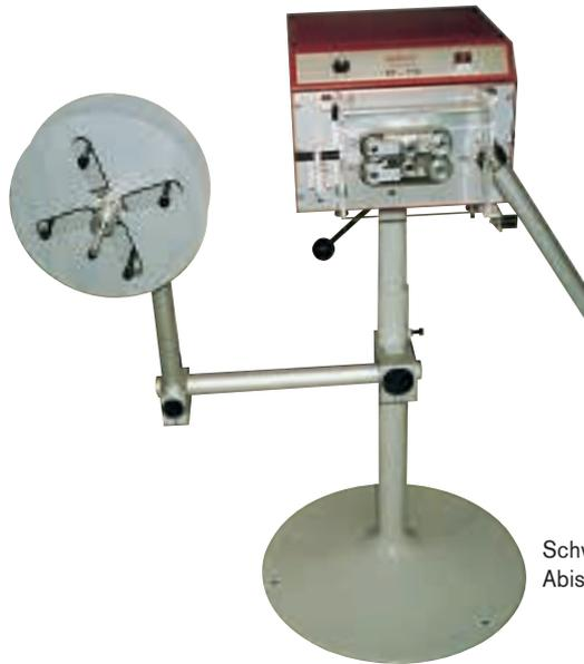
Schwenkarm mit Kabelrollenhalterung zu Abisolierautomat.
